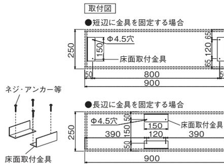
取付図を参照の上、床面取付金具を本体の短辺もしくは長辺に取り付ける方向で位置決めし、固定します。
