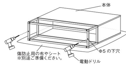
床面に傷防止の布やシートを敷いてから本体を横に倒します。パイプ脚の底面短辺中央に下穴があいいますので、Φ5ドリルまたはアンカーの径にあわせたドリル径で穴を貫通させてください。※別位置に穴を開ける場合は短辺(250mm)にて穴開けを行ってください。長辺900mm、1200mmは鋼材が入っていますので、穴加工に手間が掛かります。
