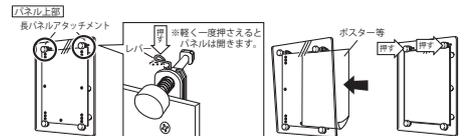
パネル上部・長パネルアタッチメントのレバー(裏面)を押さえ、パネルを開きます。横のすき間からポスターを差し込みます。パネルアタッチメントを押して、パネルを閉じ、セット完了です。
