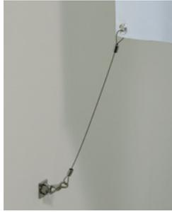
写真はハトメ加工したシートにM-912、M-910とワイヤー1.5φ、サーキュラスリーブを使って、絡み止め加工、取り付けした例です。
