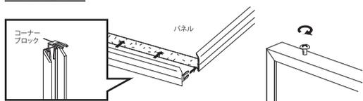
フレームにコーナーブロックを差し込み、フレームとパネルを組み立てます。フレーム側面に穴をあけてタッピングビス・木ネジ等でしっかりと固定します。
