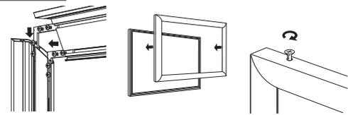
カバーフレームにコーナーブロックを差し込んで4辺を組みます。フレームを用意したパネルにかぶせます。フレーム側面に穴をあけてタッピングビス・木ネジ等でしっかりと固定します。
