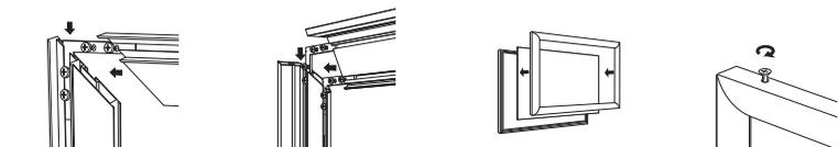
ベースフレームにコーナーブロックを差し込んで4辺を組みます。 カバーフレームにコーナーブロックを差し込んで4辺を組みます。 組んだベースフレームに面版を取り付け、カバーフレームをかぶせます。 フレーム側面からビスでしっかりと固定します。
