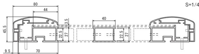
面版寸法=フレーム外寸法-73mm(コトリ1mm)
