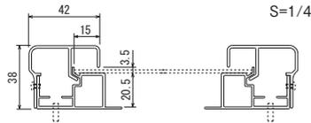
面板寸法=フレーム外寸法-55mm(ユトリ1mm)
