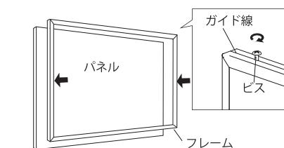
カバーフレームをパネルにかぶせ、フレーム側面のガイド線に合わせてタッピングビス・木ねじ等を打ち込み、しっかりと固定します。
