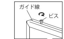
カバーフレームをパネルにかぶせ、フレーム側面のガイド線に合わせてタッピングビス・木ねじ等を打ち込み、しっかりと固定します。
