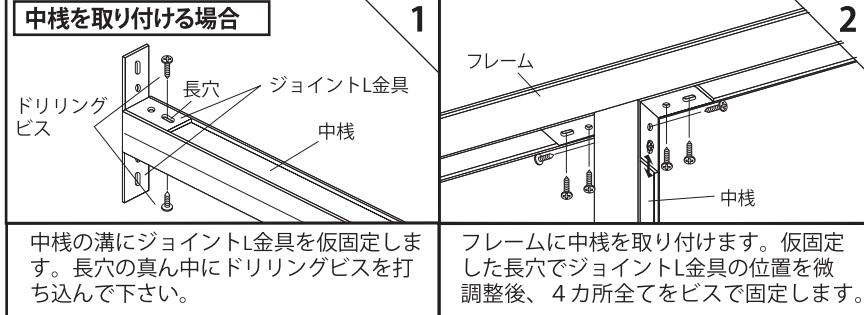
中桿の溝にジョイントL金具を仮固定します。長穴の真ん中にドリリングビスを打ち込んで下さい。
