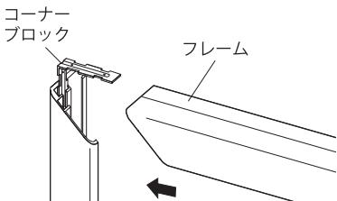
フレームにコーナープロックを差し込んでフレームを組み立てます。
