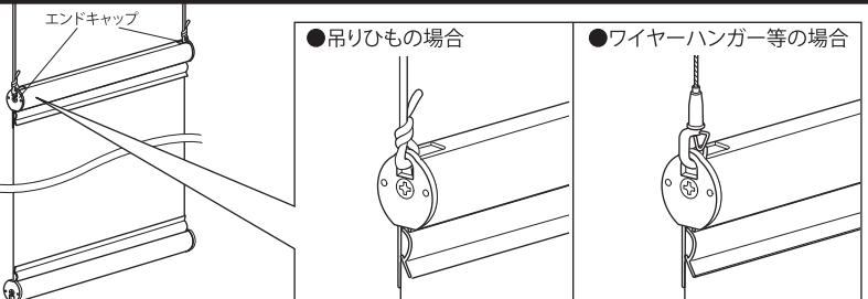
エンドキャップの穴に吊りひもを通したり、ワイヤーハンガー等を引っ掛け、吊り下げて下さい。
