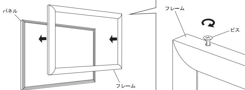
フレームをパネルにかぶせ、タッピングビス・木ねじ等でしっかりと固定します。
