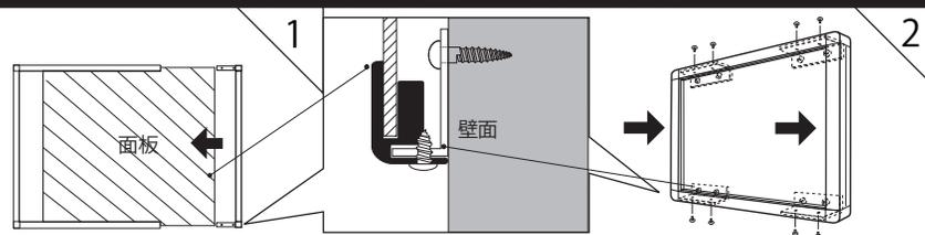
取り外したフレームの一边を外し、アルミ複合板などの面板をフレーム溝に挿入します。
