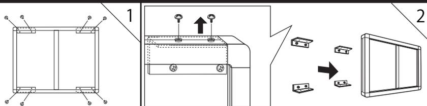
正面より壁面取付アングルに壁面取付穴を開け、壁面に固定します。
