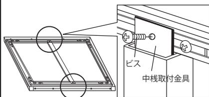
本体フレーム裏面の中棧取付金具を、ビスで固定します。
