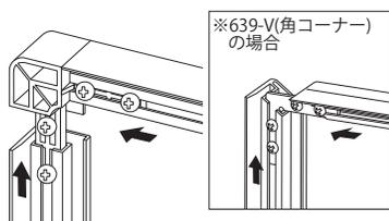
フレームにコーナーブロックを差し込み、ビスを締めて4辺を組み立てます。
