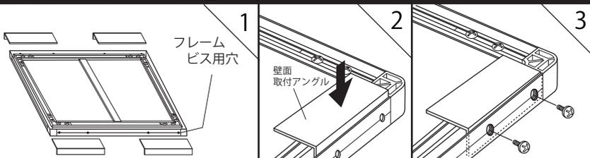
フレーム側面の穴開けガイドライン上に、壁面取付アングルの寸法に合わせて必要数のフレームビス用穴(ビス径より大きめ)を開けます。
