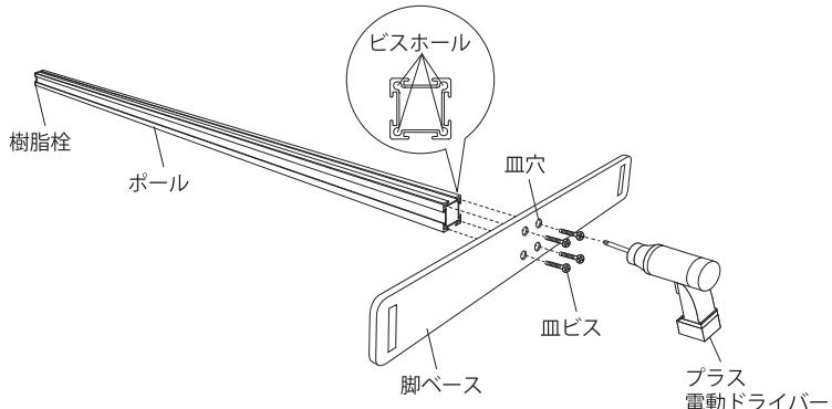
ポールの底面(樹脂栓のついていない面)のビスホールに脚ベースの皿穴を合わせて皿ビスで固定します。
