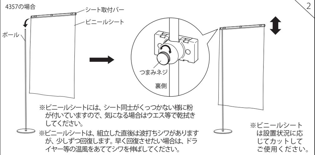
ポールにシート取付バーを差し込み、シート取付バーの位置を決め、裏側のつまみネジを締めて固定します。
