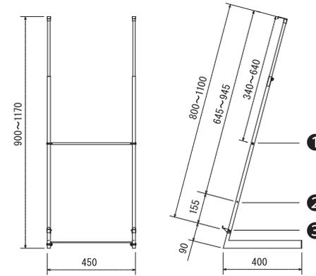
パネルサイズに合わせてポール・受け金具を取付けて下さい
